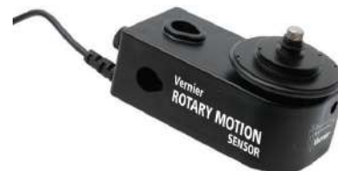
Figura 2: "Rotary Motion Sensor", da Vernier, usado para a obtenção dos dados experimentais.
